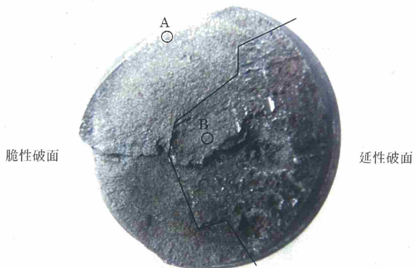
写真3 破断面写真（ボルト先端側）
