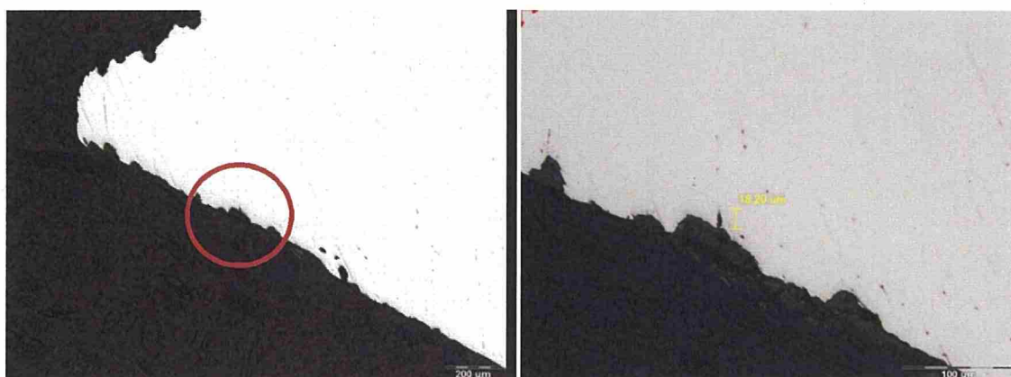
写真 9 不完全ねじ頂部断面（A-1）
