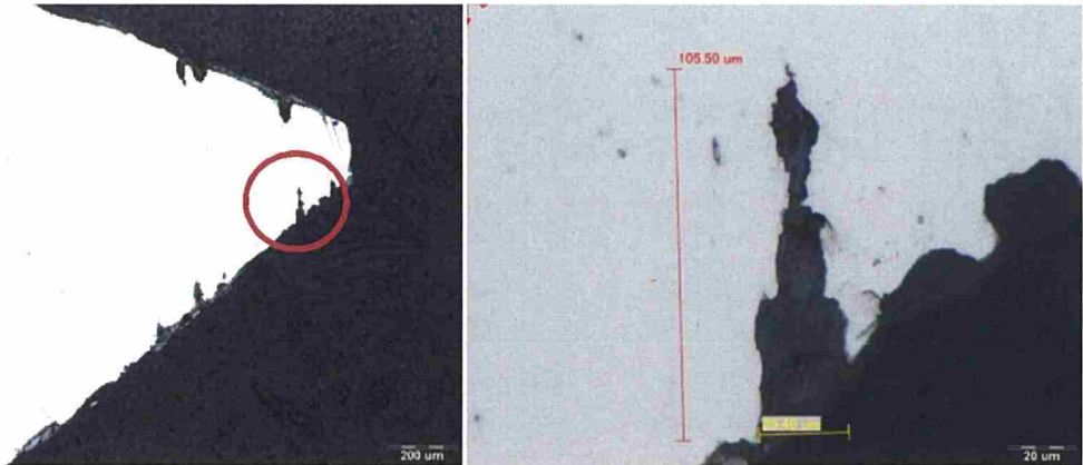
写真 13 不完全ねじ頂部断面 (A-3)
