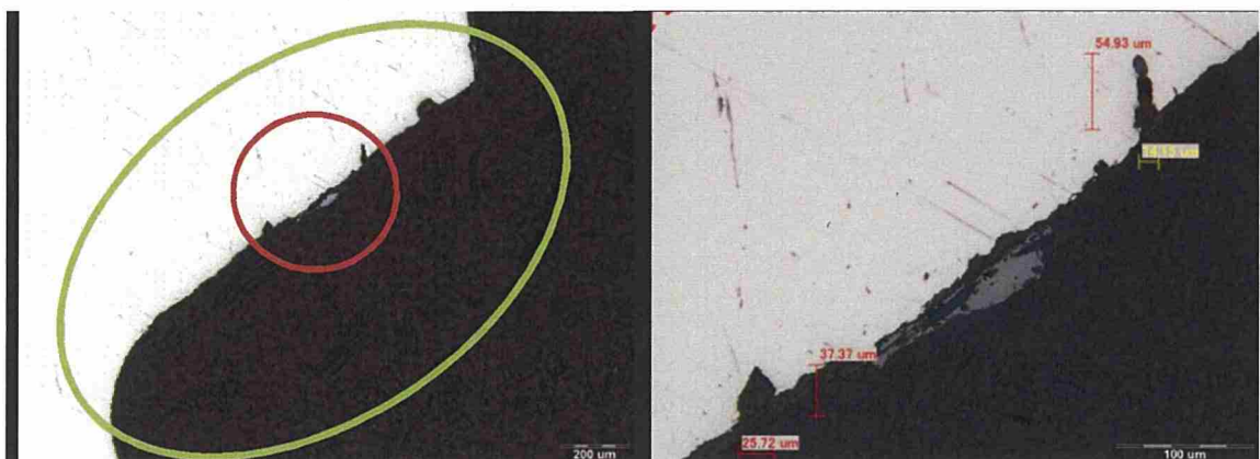
写真 12 不完全ねじ部断面（A-2）（MT 指示模様部付近）
