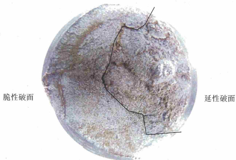
写真4 破断面写真（フランジ側）
