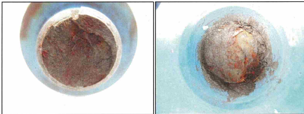
フランジ側破断面
