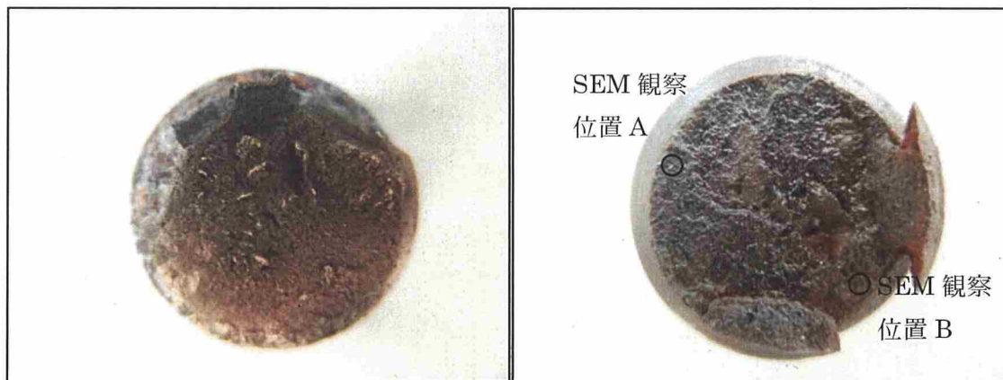
フランジ側 ねじ先端側 写真 21463-2 破断面のマクロ写真 (容器 No. 21463 の折損ボルト)
