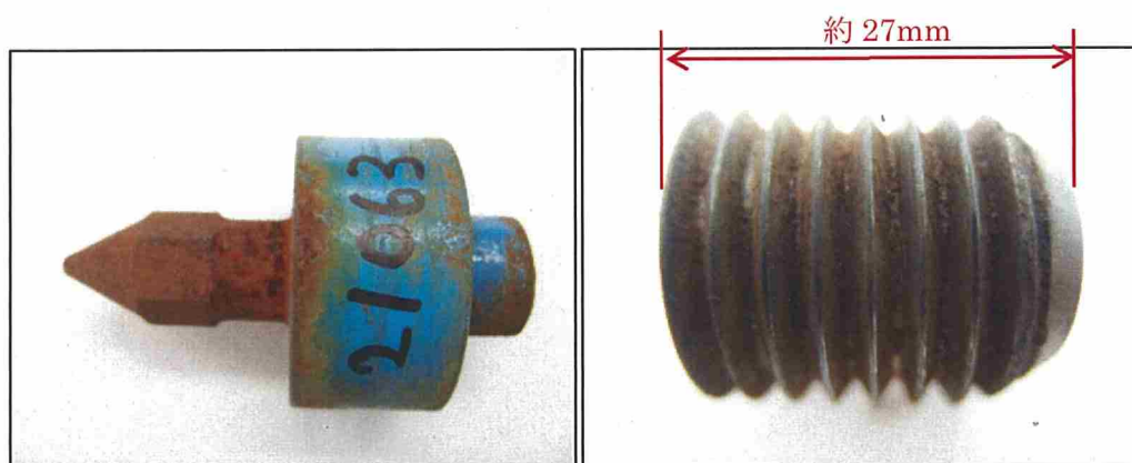
破断後外観（フランジ側）
