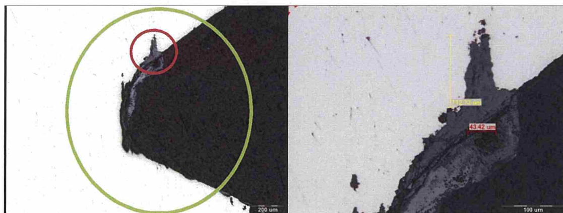
写真 8 不完全ねじ谷部断面（A-1）（MT 指示模様部付近）
