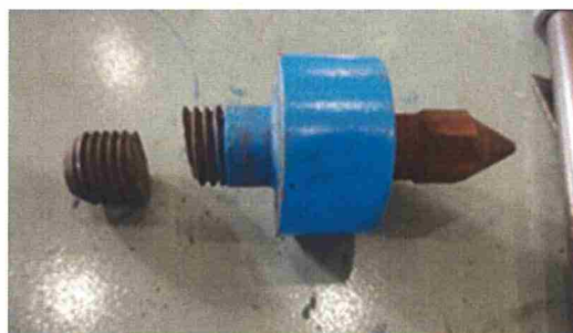
写真 2.1 折損した蓋ボルト (No. 21892)
