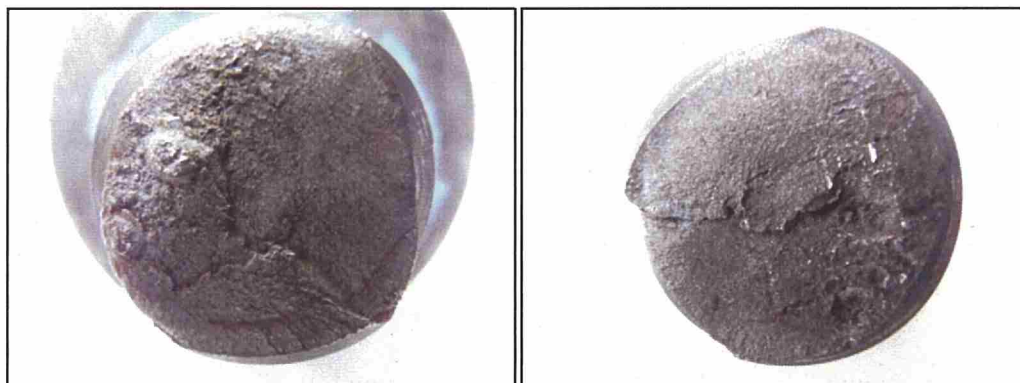
フランジ側破断面
